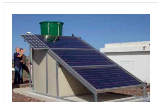
Abbildung 7 Wasserentsalzung durch Membrandestillation, Funktionsprinzip und Kompaktsystem des Fraunhofer ISE
